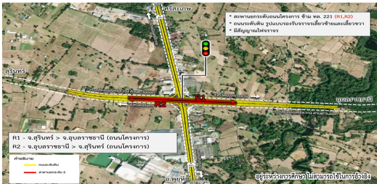
รูปที่ 8-8 รูปแบบที่เหมาะสมจุดตัดทางแยกบริเวณจุดตัดของโครงการ บนทางหลวงหมายเลข 221
